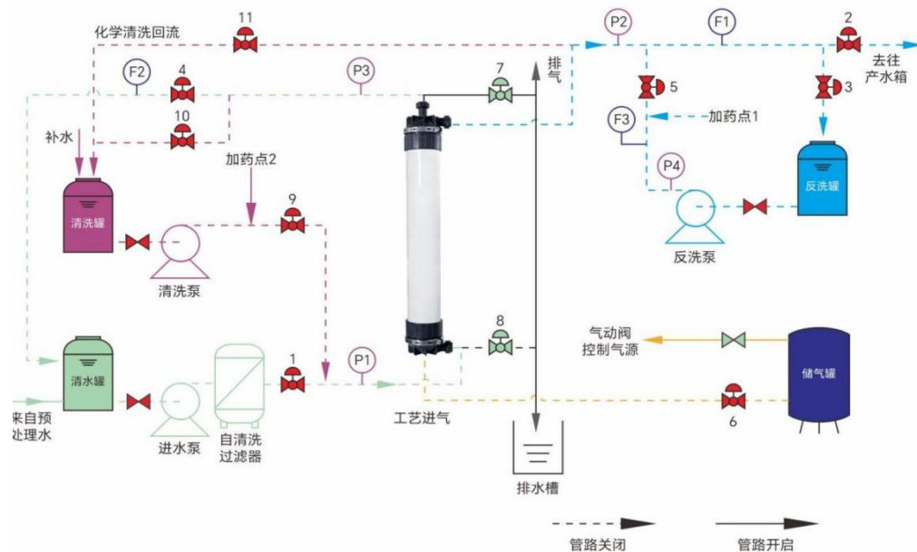
图3-6 超滤系统排污状态示意图
